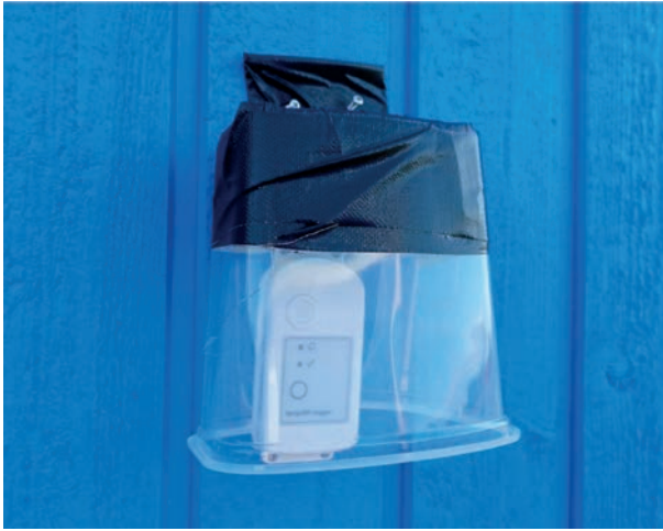
Ulkolämpötilan ja kosteuden mittaus
